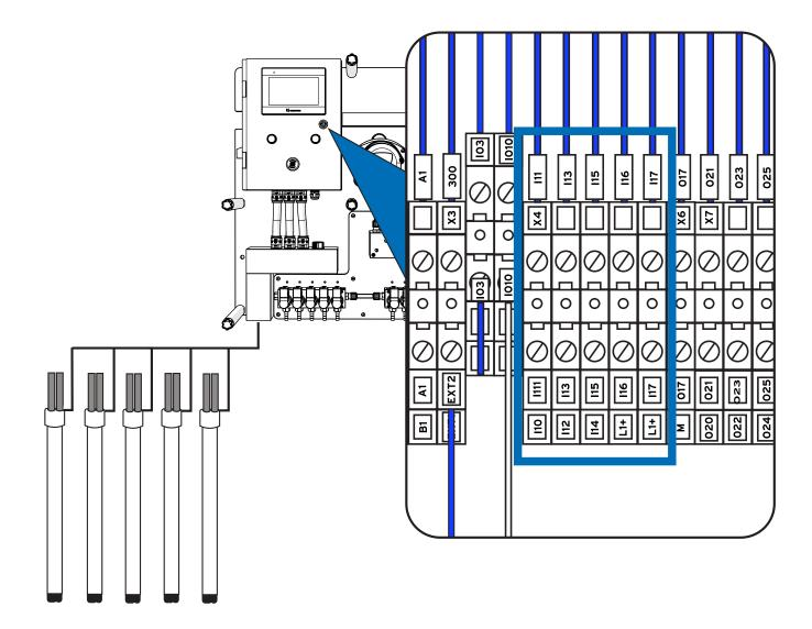
Um die externen Saugstangen an die Maschine anzuschließen, verwenden Sie die Eingänge I10 bis I17, wie oben angegeben.
