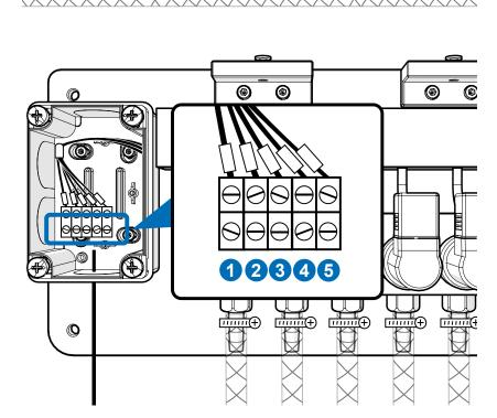
Verwenden Sie ein 7x1mm^2 Kabel für die Verbindung zwischen der Steuerkabine und dem Verteiler. Schlieβen Sie den Verteiler an die Klemmleiste X7 an. Jeder Klemmenanschluss entspricht den von links nach rechts nummerierten Ausgängen, wobei die Anzahl von der Reihenfolge abhängig ist. Nachstehend finden Sie den Schaltplan für das Hauptgerät.
