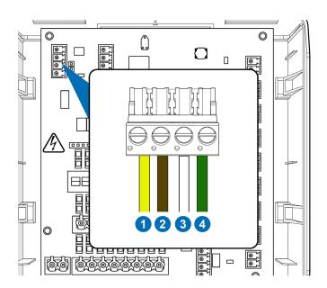
Um die externe Kommunikationsbox an das Gerät anzuschließen, verbinden Sie den Anschluss X2 an der Hauptmaschine mit dem Anschluss X1 an der Kommunikationsbox.
