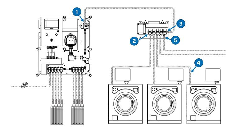
Für den Anschluss der Geräte, des Verteilers und der Unterlegscheiben sind **PVC-Rohre mit 10x16** Maschen und Edelstahlschellen zu verwenden.
