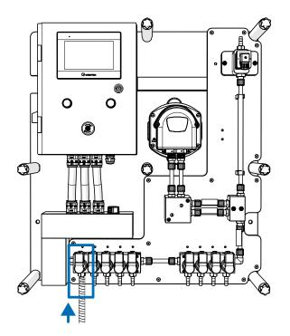
Schließen Sie die Wasserversorgung an das Magnetventil ganz links auf der mittleren Platte des Geräts an.
