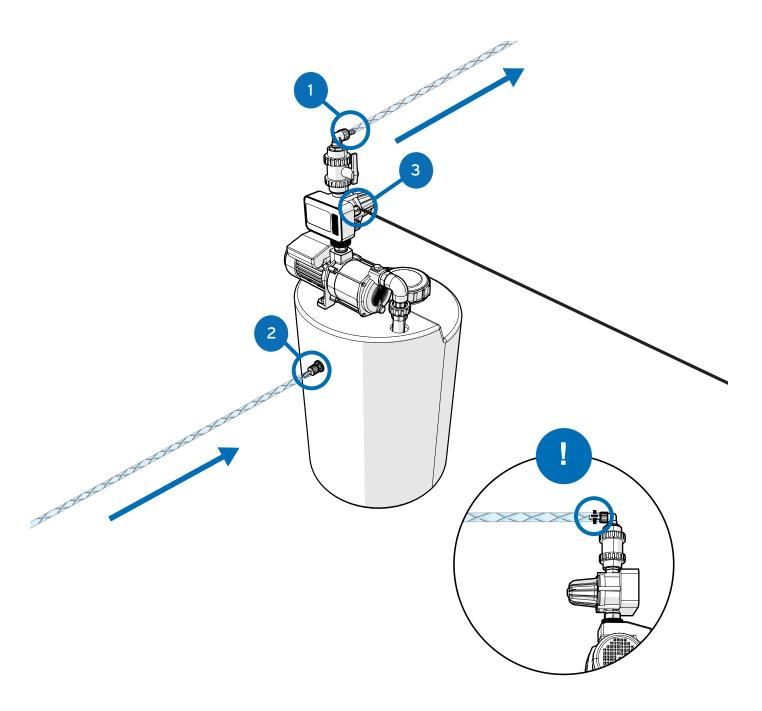
Bitte beachten Sie, dass das Gerät einen Durchfluss von min. 2/I pro min - max. 10/I pro min und einen dynamischen Druckbereich von 1,5 bar (min.) - bis 3 bar (max.) benötigt. Eine Druckerhöhungsanlage wird immer dann empfohlen, wenn keine gleichmäβige Versorgung vorhanden ist.
