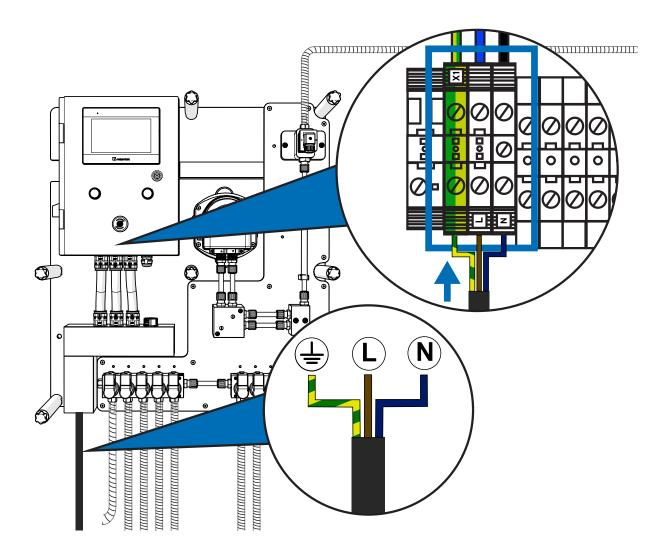
Für die Stromversorgung des Geräts müssen Sie 3x1'5mm2 Kabel verwenden. Führen Sie das Kabel durch den Kanal unten links und verwenden Sie eine der Kabelverschraubungen, um es sicher in den Schaltschrank einzuführen. Schließen Sie es an die mit X1 gekennzeichneten Klemmen links unten an den Anschlüssen an.
