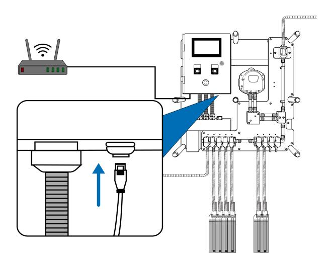
Um Ihr Gerät mit dem Internet zu verbinden, schließen Sie einfach ein Ethernet-Kabel über den Anschluss an der Unterseite der Hauptbox an einen beliebigen Router an.
