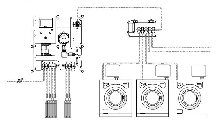
Diese Abbildung zeigt den Standardaufbau einer Multiplex-Einheit mit einem Kanal, wobei unter "Kanal" eine Gruppe von Produkten zu verstehen ist, die in denselben Verteiler eingespritzt und zu einem Verteiler (Waschmaschinen) oder einer Einspritzung (Tunnel) geleitet werden.
